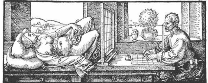
3. Una de las ilustraciones de los mecanismos persépticos de Durero, de su Underwysung der Messung (1538). En este caso vemos cómo la máquina se utiliza, con un artista empleando una red y un lente para dibujar una figura desnuda con las proporciones correctas requeridas para crear la ilusión de profundidad.
