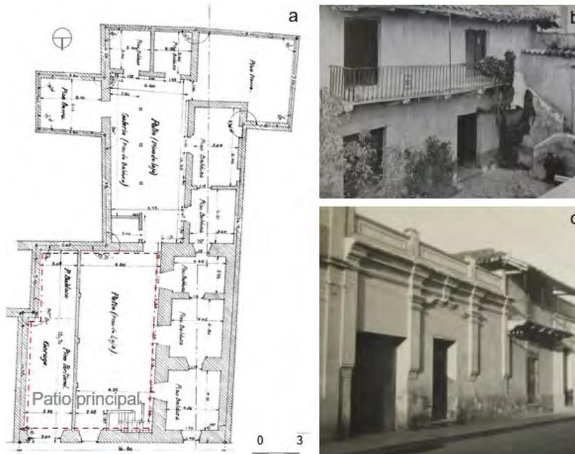
Figura 2. Casa de los Uriburu. a: Planta baja, registro preliminar correspondiente al Plano N° 1 (1943) (en línea punteada se destaca el perímetro original del patio principal). Repositorio: Archivo CeDiap. b: Sector del patio principal que permaneció a cielo abierto (el ángulo inferior derecho corresponde al techo de chapa del garage). Fuente: Solá, 1942, Lám. LXXXIII. c: Fachada principal. Repositorio: Archivo Academia Nacional de Bellas Artes.
