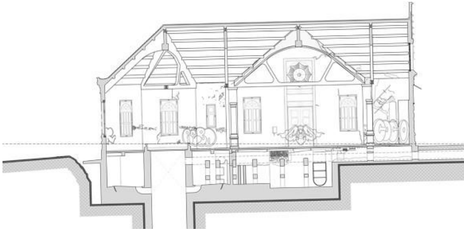
Fig. 10. Corte longitudinal de la casa de bombas núm. 3 Nativitas (2021). Se observan degradaciones físicas en muros, pisos y puertas, así como grafitis. Fuente: Registro arquitectónico por los autores.
