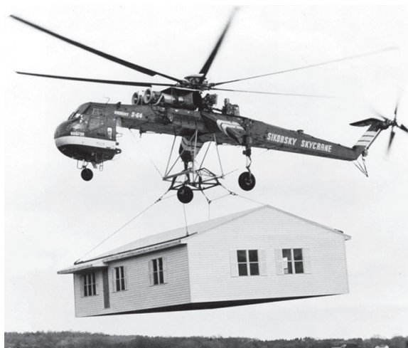
Figura 01. Un helicóptero Sikorsky S-64 Skycrane transportando una casa prefabricada por Utility Services, 1967. Estableciendo una analogía entre el concepto de transculturación y una fotografía que parece sacada de un filme de ciencia ficción, se hace alusión a todos aquellos conceptos arquitectónicos, urbanos y sociales que han sido transportados de un continente a otro con una ligereza y superficialidad un tanto absurda. Fuente: Dominio público.
