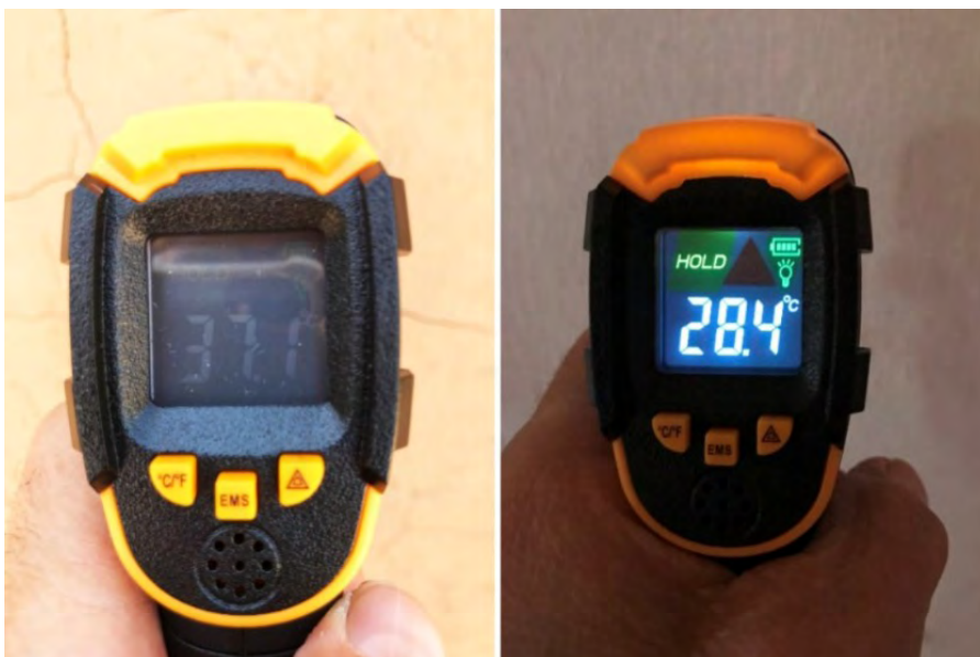
Figura 7. Diferencial de temperatura de 8.7 °C medidos en el mismo momento fuera y dentro de una casa de Bajareque Cerén realizada por Cooperación Comunitaria en Ixtepec, Oaxaca. Foto: I. Hastings.
