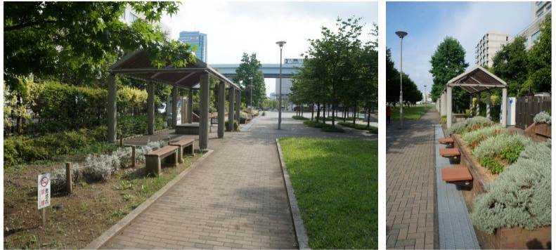
Figura 10. Ejemplo de bancas en Rinkai Park, cuyo asiento se desmonta para convertirse en estufas y poder cocinar en caso de que el parque se convierta en un refugio provisional por causa de un desastre. Atrás de las bancas, toldos deslizables hasta el suelo para servir como protección y permitir el refugio. Fuente propia. Figura 11. Ejemplo de bancas en Rinkai Park, cuyo asiento se desliza hacia arriba para convertirse en sanitario adaptando una cubierta y conectando directo al drenaje en caso de que el parque se convierta en un refugio provisional por causa de un desastre. Fuente propia.
