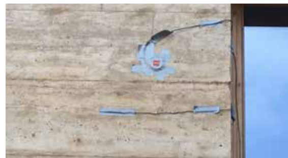
Figura 4. Instalación exterior de los equipos de medida en el muro estudiado. (Fuente: la autora).
