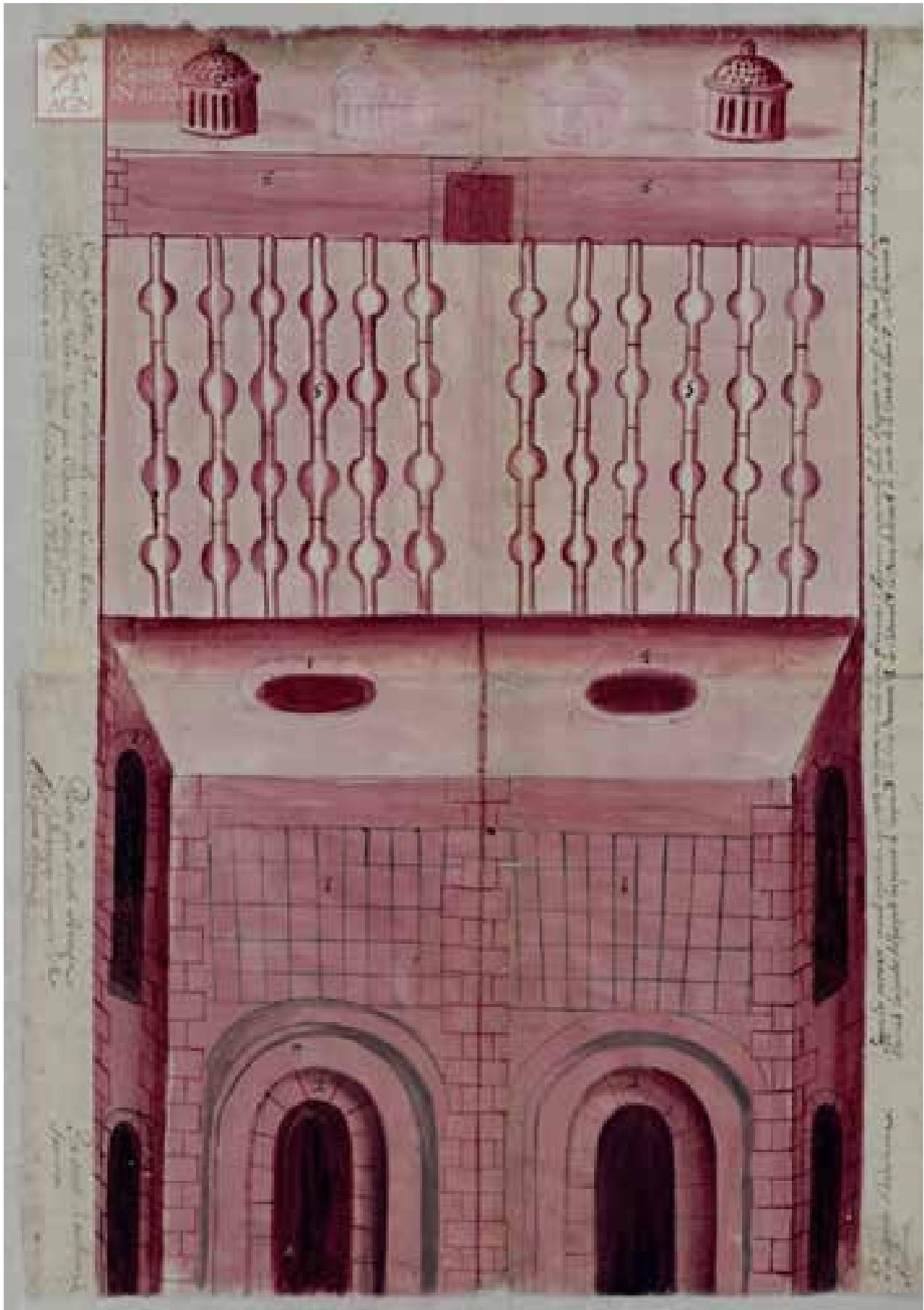
**Figura 3.** Hornos de Aludeles. Recuperado de Minería, (1773) AGN
